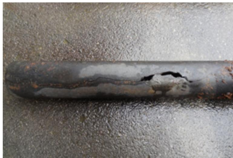
Längsrisse mit Abplatzer bei duktiler Gussleitung
