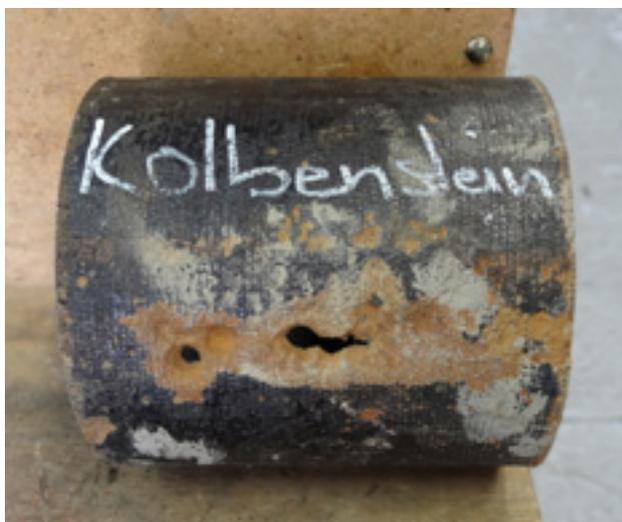
Lochfrass (Korrosionsschaden) bei duktiler Gussleitung
