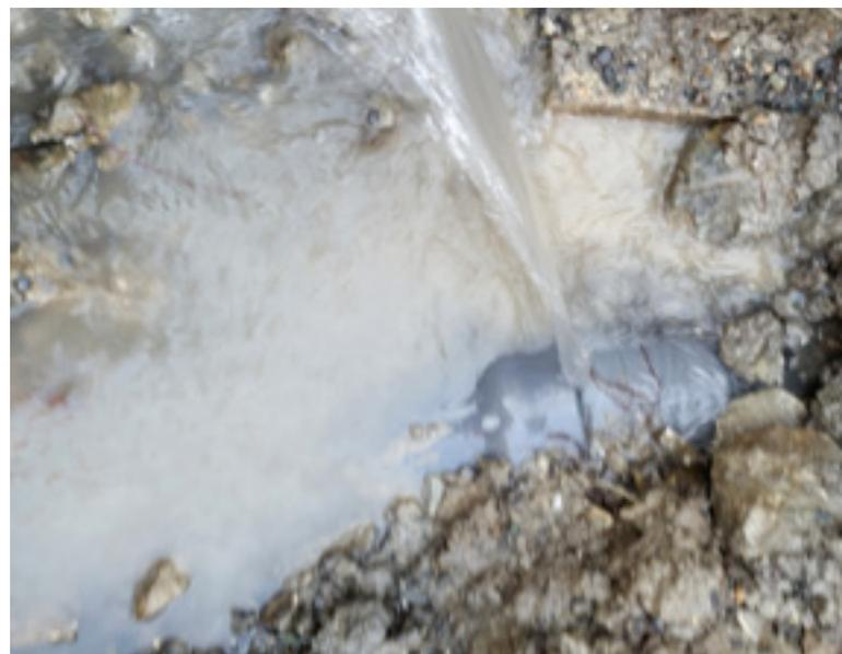
Spannungsrisse bei PVC-Druckleitung (seltener Fall)
