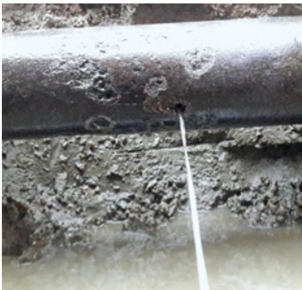
Lochfrass (Korrosionsschaden) bei duktiler Gussleitung
