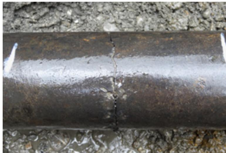
Spannungsriss bei duktiler Gussleitung
