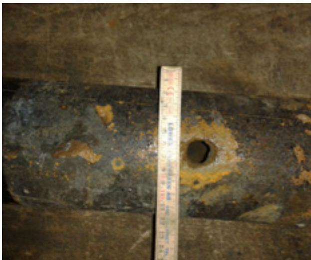
Lochfrass (Korrosionsschaden) bei duktiler Gussleitung
