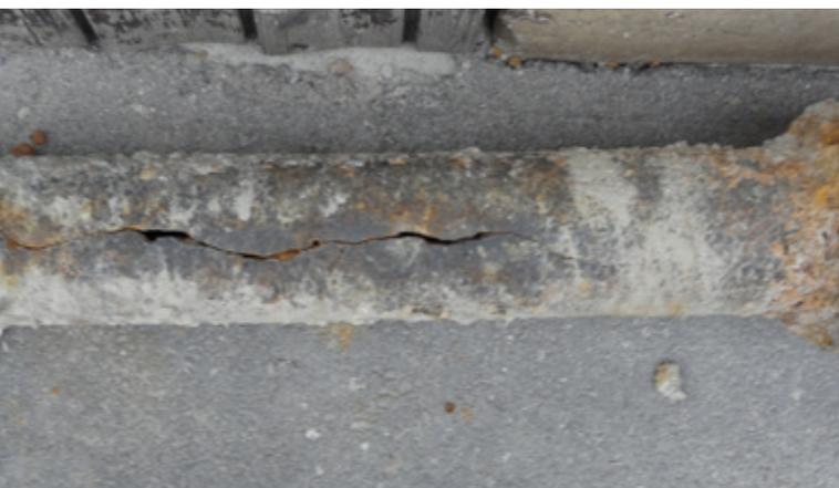
Längsriss (Korrosion- und Spannungsriss) bei Graugussleitung in der Dorfstrasse, Montlingen
