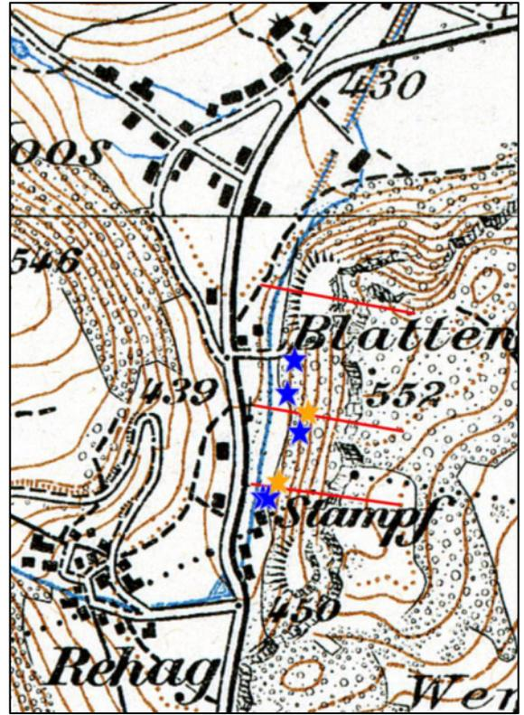
Abb. 08 und 09: Topographische Karten 1932 und 1933 mit den Standorten der Bagger Sondierungen (blau) und der Sondierbohrungen (orange) sowie den 3 Profilsuren der Abb. 4 bis 6 (rot). Quelle: [www.swisstopo.ch](http://www.swisstopo.ch).
