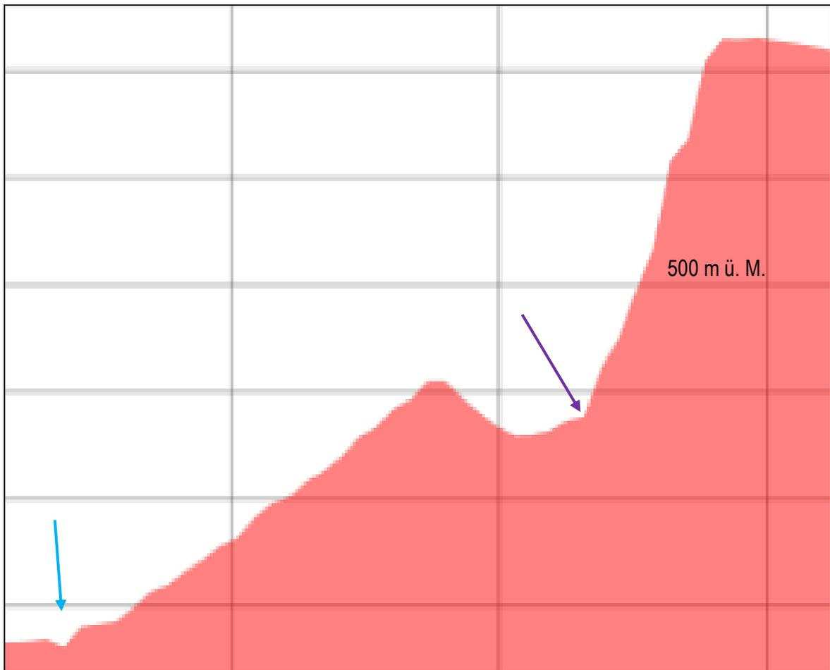
Abb. 06: Profilschnitt Nord im Massstab 1:500 mit dem Einschnitt des Aubachs (blauer Pfeil) und dem untersten Bereich der Felsaufschlüsse (violetter Pfeil).
