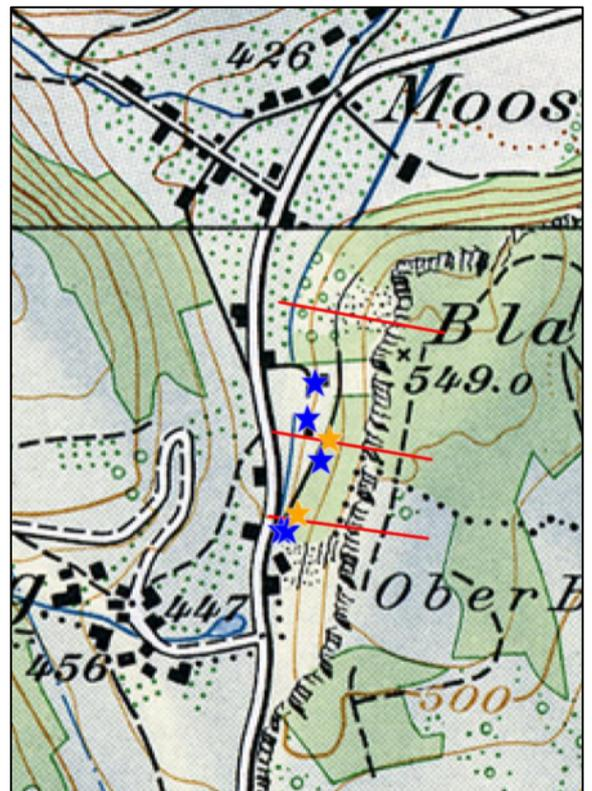
Abb. 10 und 11: Topographische Karten 1952 und 1953 mit den Standorten der Bagger Sondierungen (blau) und der Sondierbohrungen (orange) sowie den 3 Profilsuren der Abb. 4 bis 6 (rot). Quelle: [www.swisstopo.ch](http://www.swisstopo.ch).
