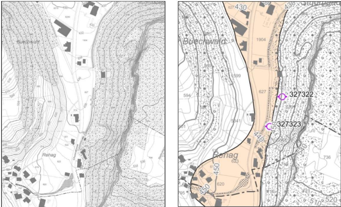
Abb. 15 und 16: Gewässerschutzkarte und Grundwasserkarte des Kantons St. Gallen aus dem Jahr 2023 im Bereich der projektierten Deponie Rehag mit den beiden im April 2020 ausgeführten Bohrungen KB1 Nord (Nr. 327'322) und KB2 Süd (Nr. 327'323).
