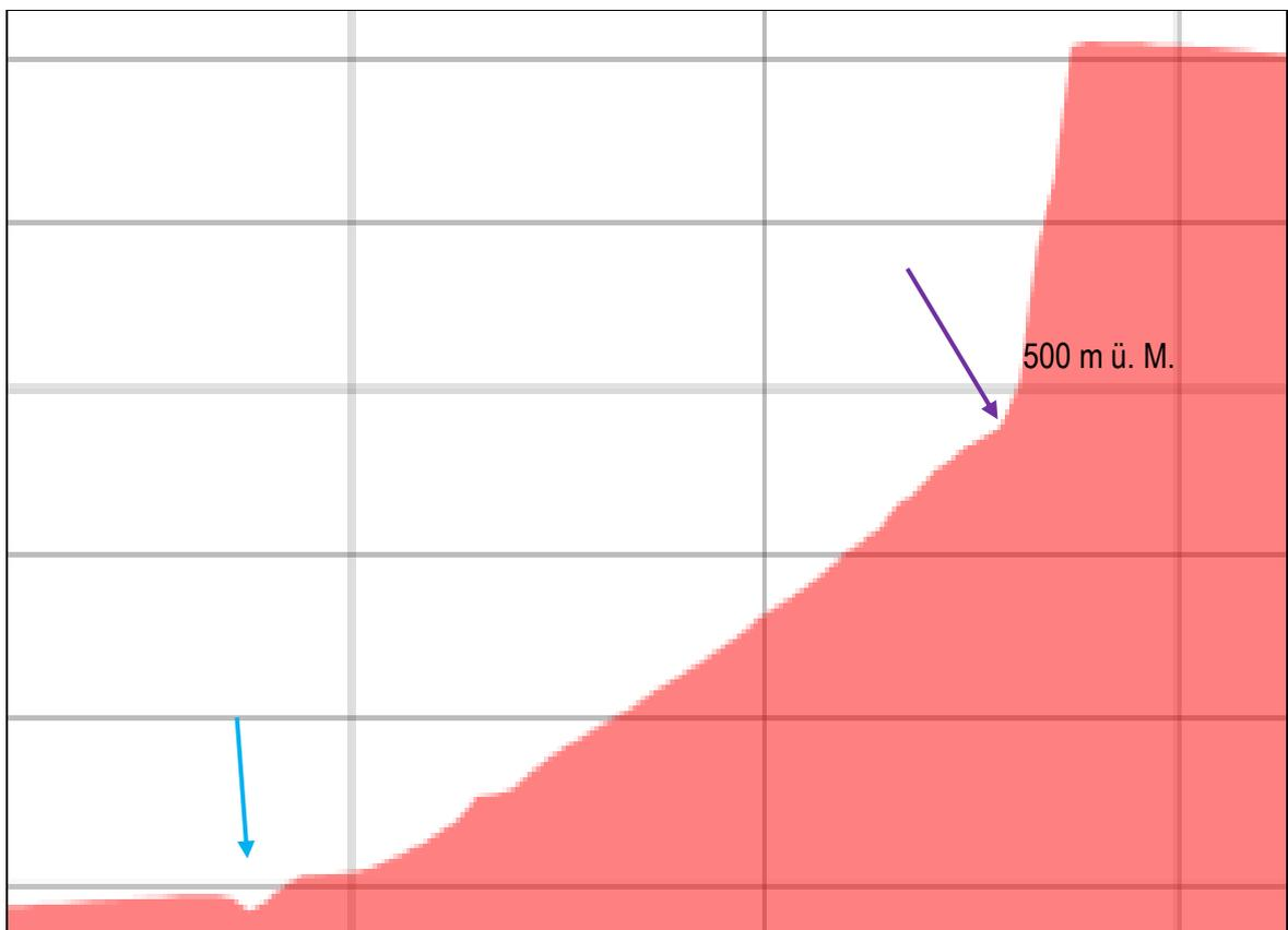
Abb. 04 und 05: Profilschnitte Süd (oben, vgl. Beilage 4.1) und Mitte (vgl. Beilage 4.2) im Massstab 1:500 mit dem Einschnitt des Aubachs (blaue Pfeile) und dem untersten Bereich der Felsaufschlüsse (violette Pfeile).
