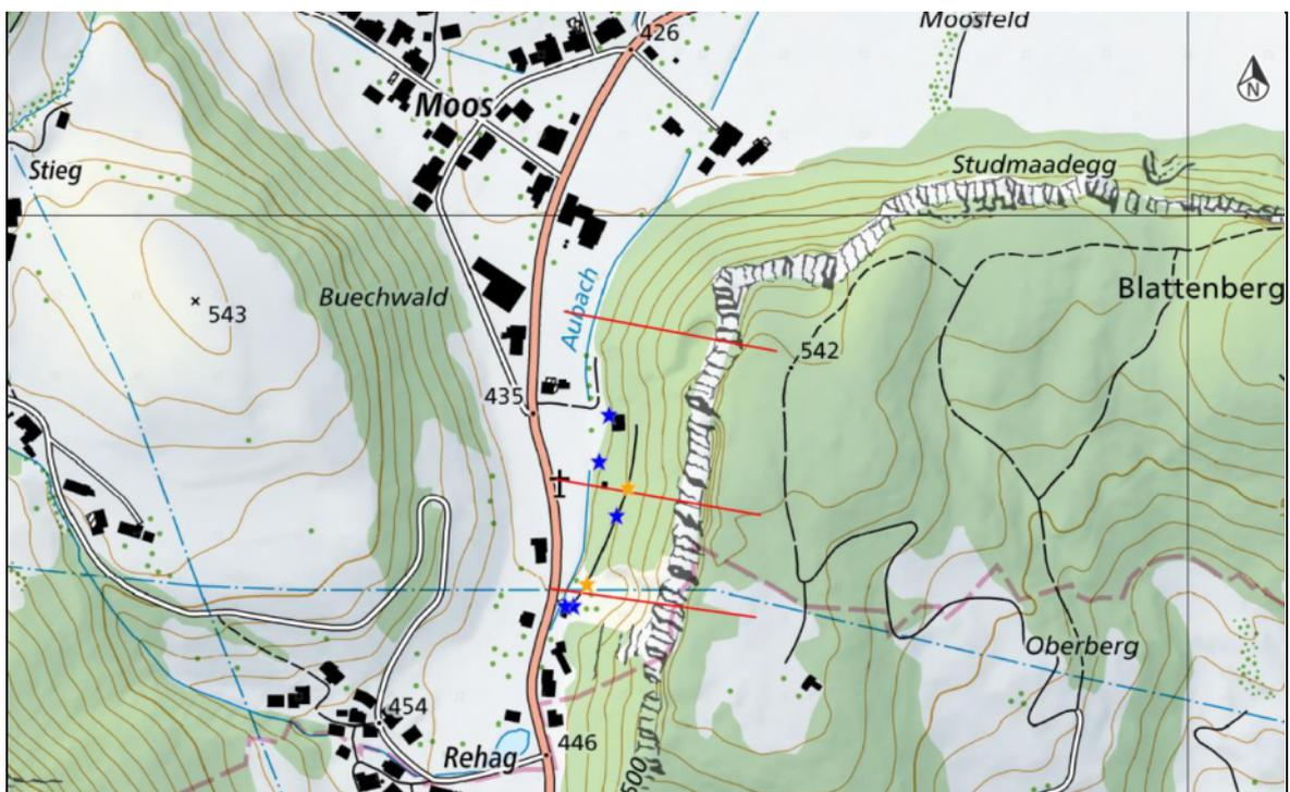
Abb. 03: Situation mit den Standorten der Baggersondierungen (blau) und der Sondierbohrungen (orange) sowie den 3 Profilsuren der Abb. 4 bis 6 (rot).
