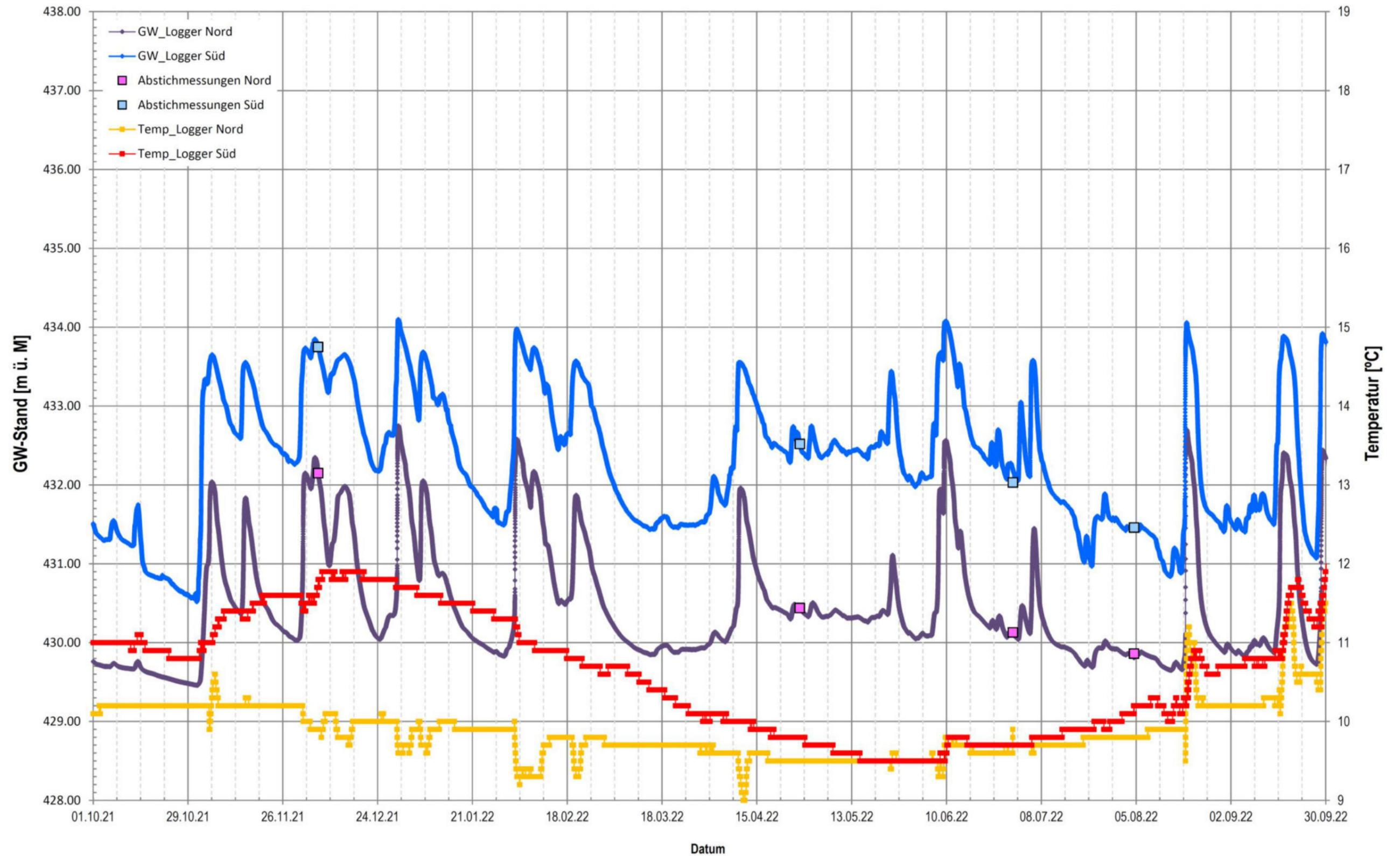
Beilage 6.3: Grundwasserspiegelmessung vom 1. Oktober 2022 bis am 30. September 2023
