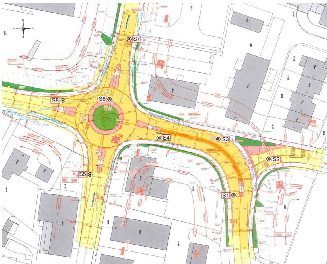
Abbildung 2: Ausschnitt aus dem Bericht: Probeentnahmeplan mit den acht Bohrkernen
