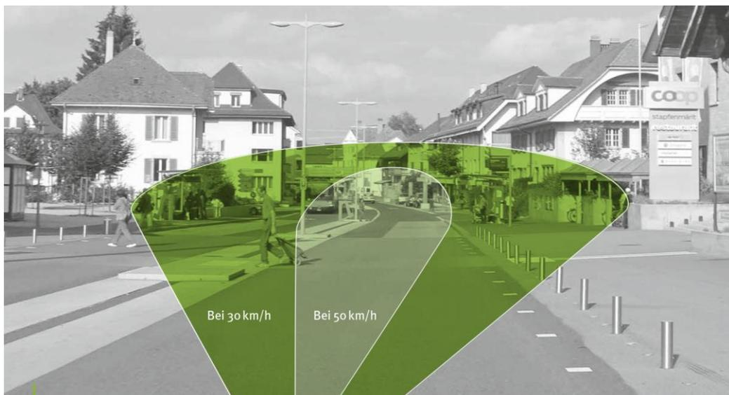
Abbildung 11: Unterschiede der Sichtfelder bei Tempo 30 und Tempo 50; Quelle: VCS 2010
