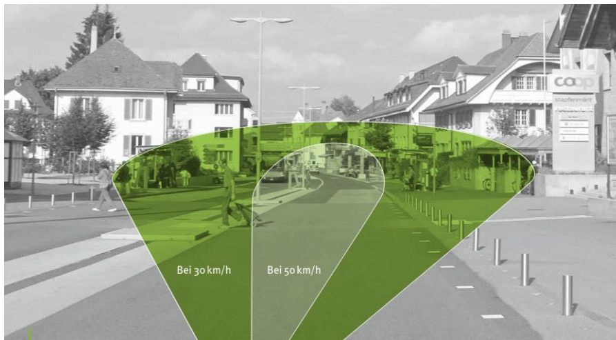
Abbildung 13: Unterschiede der Sichtfelder bei Tempo 30 und Tempo 50; Quelle: VCS 2010
