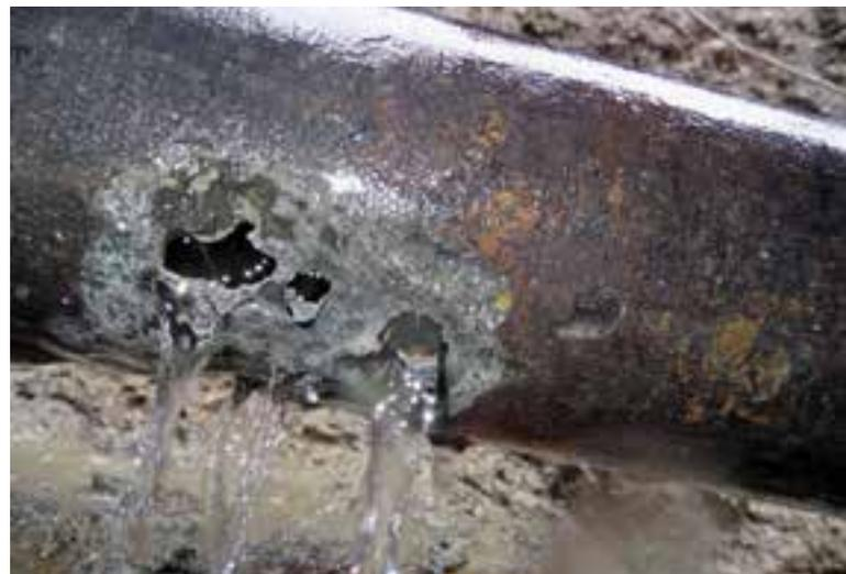
Lochfrass (Korrosionsschaden) bei duktiler Gussleitung
