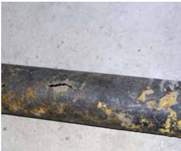
Längsrisse mit Abplatzer bei duktiler Gussleitung
